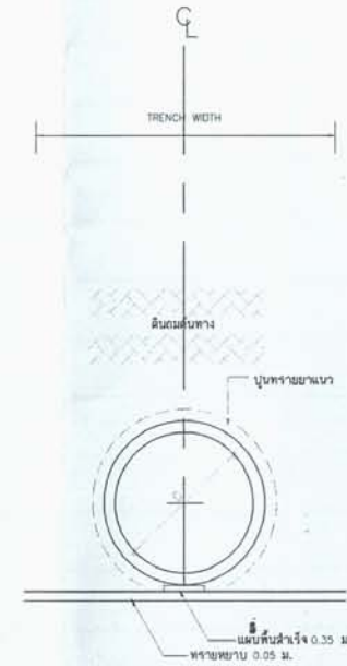
รูปขยายการวางท่อระบายน้ำ
